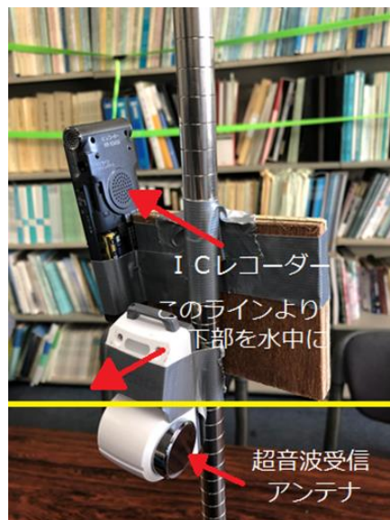
写真-3 受信側装置外観
