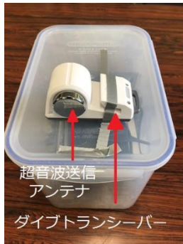
写真-1 送信側装置外観
