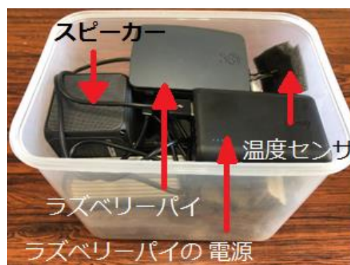
写真-4 送信側温度計測装置の内部
