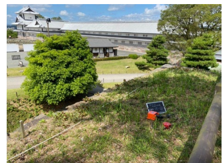
写真-1 常時微動測定状況
