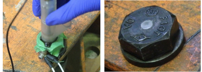
(a) 電解研磨状況 (b) 電解研磨後のボルト状況 写真3 電解研磨状況
