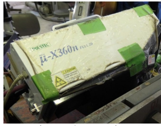
写真2 ポータブル型X線残留応力測定装置
