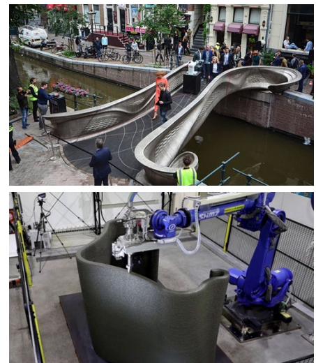
図1 (上) オランダで架設された3Dプリント鋼歩道橋, (下) RC柱の3Dプリント埋設型枠（清水建設）
