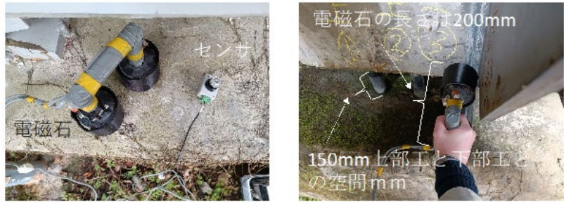
図 4 既設のダブルックバンド橋での電磁石式の磁場調査機器の計測
