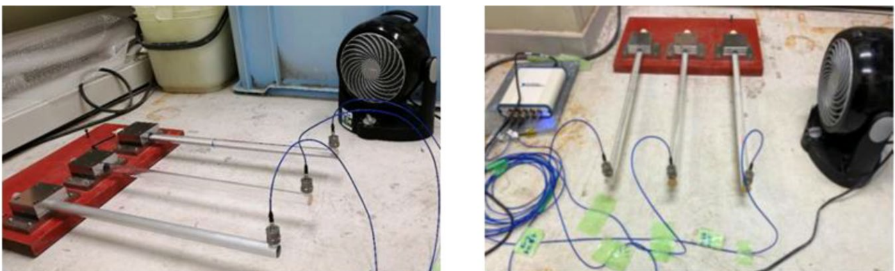
図-1 EMM-ARMの測定セットアップ
