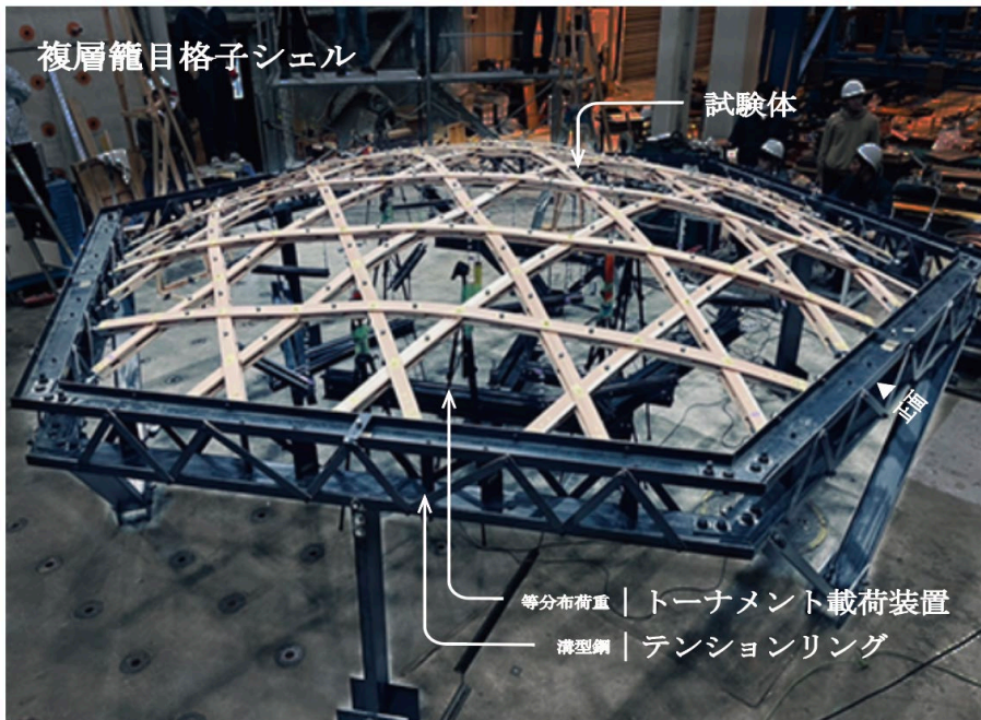
図7 実験装置と試験体(複層)
