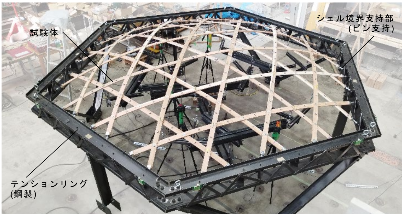
図 1 実験装置と試験体(単層)
