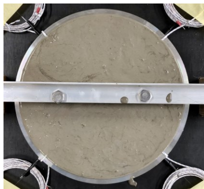
7. ジオポリマーコンクリート (リング拘束供試体)
