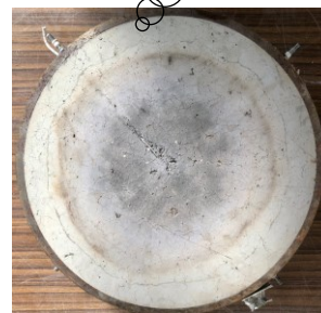
16. 本実験における加熱後の加熱面の様子
