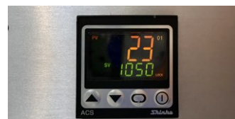
15. 加熱試験の様子 (1050°Cを確認)
