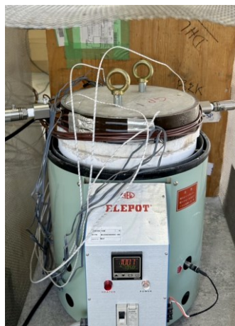
13. 加熱試験の様子 (小型電気炉の上にリングの供試体を設置)
