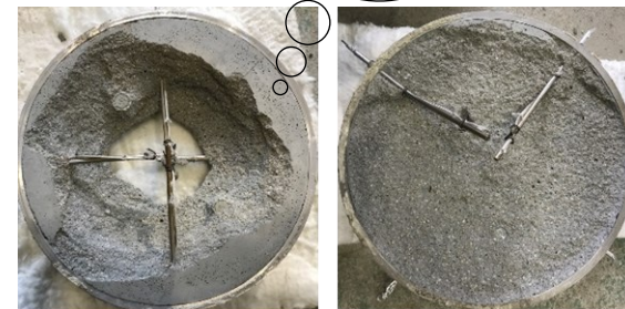
17. 高炉スラグ系耐熱性断面補修材における加熱後の加熱面の様子
